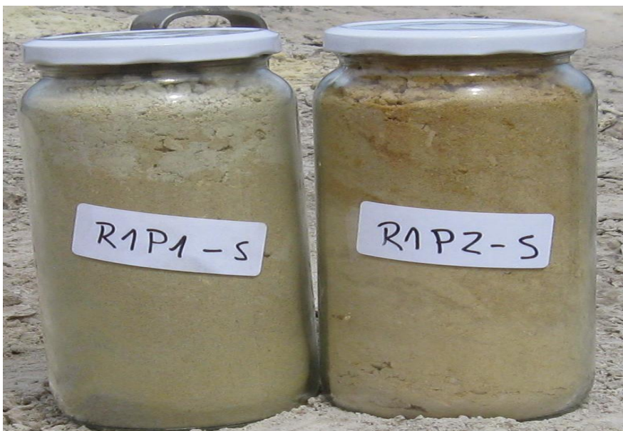
Foto 1: Envases tipo frasco conservero, con tapa ancha y sus etiquetas de identificación.
