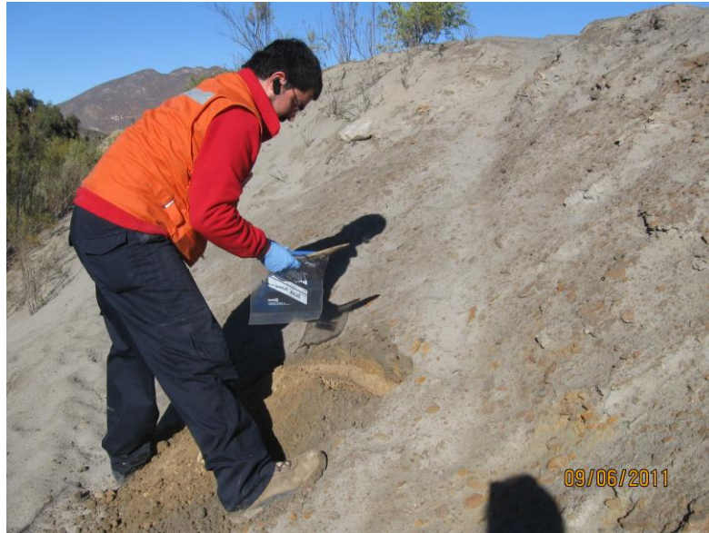
Foto 6: Extracción de muestra superficial de relave usando pala manual.
