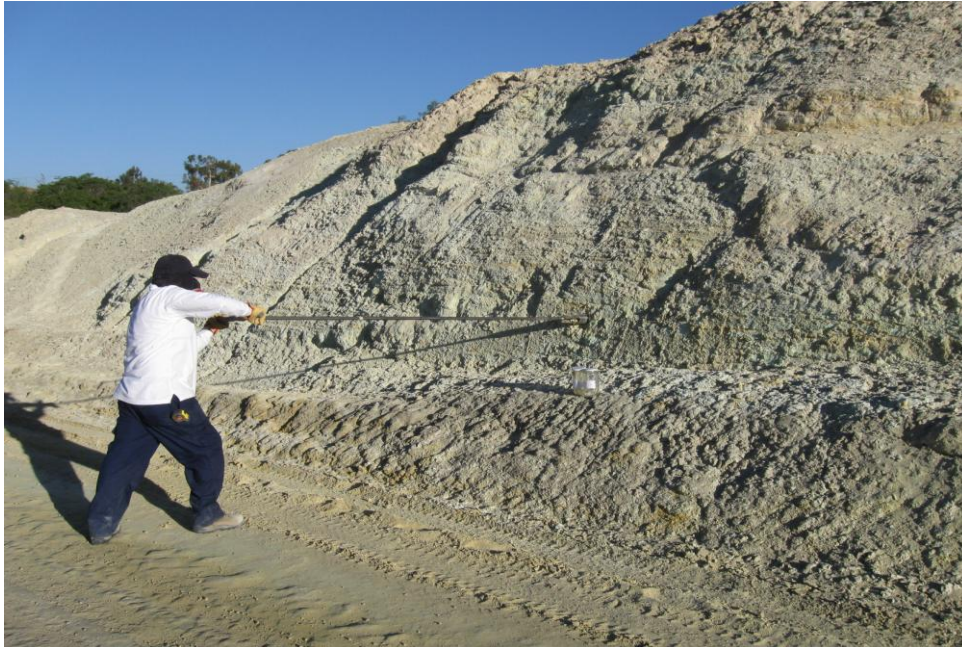
Foto 5: Ubicación del barreno para la extracción de muestras desde el lateral del relave.
