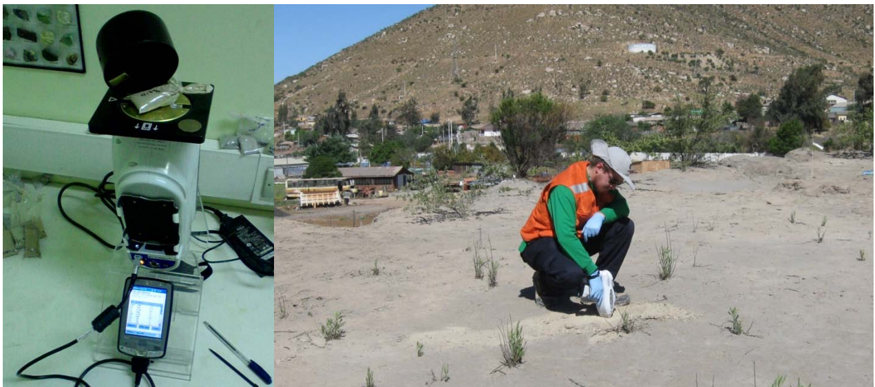
Figura 9. Análisis de muestras por XRF en el laboratorio y en terreno.
