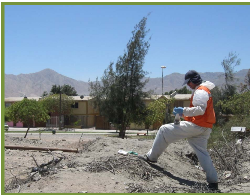
Figura 17. Toma de muestras en relave Porvenir. Dado que no fue posible acceder a la propiedad que contiene el relave, las muestras fueron tomadas de suelos en zonas afectadas por un derrame del residuo.
